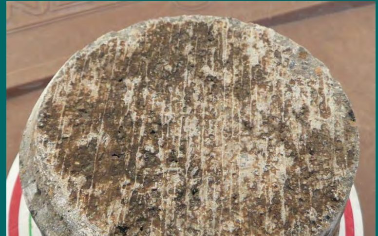
Betonkern – ohne Schäden
